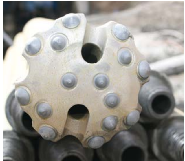
Bohrkopf für eine Geothermiebohrung
