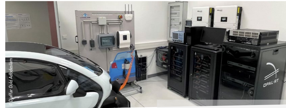
Szenarien von Cyberangriffen auf Mikronetze wurden in einem OPAL-RT-Echtzeitsimulator nachgebildet, um der Realität so nahe wie möglich zu kommen.
